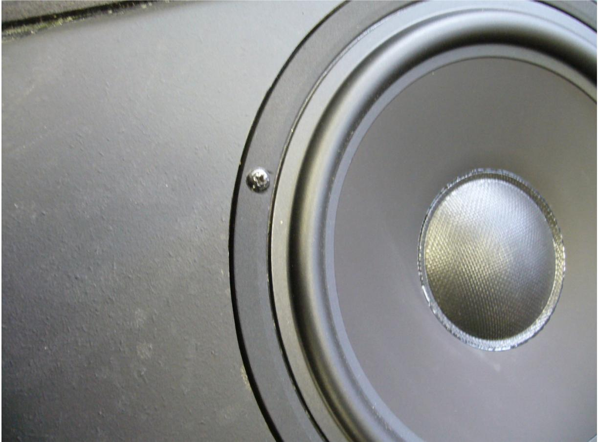
Nun konnte der Lautsprecher mit seinen Seitenteilen, der Bassabdeckung und neuen Haltebändern (Klett und Schaumstoff) komplett montiert werden und wurde ca. 30 Stunden mit mittlerem bis hohem Pegel nonstop eingespielt. Danach wurde die erste Messung des gesamten Frequenzganges wieder im Raum, in ca. 3,5m Abstand und mit größerem Wandabstand durchgeführt.
